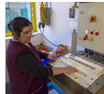
→ Pour le montage des coffrets, la machine développée par le client, dispose de capteurs.
