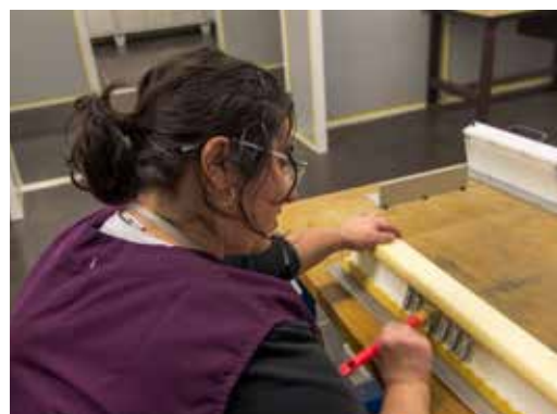
→ La première étape est le graissage des vis.
